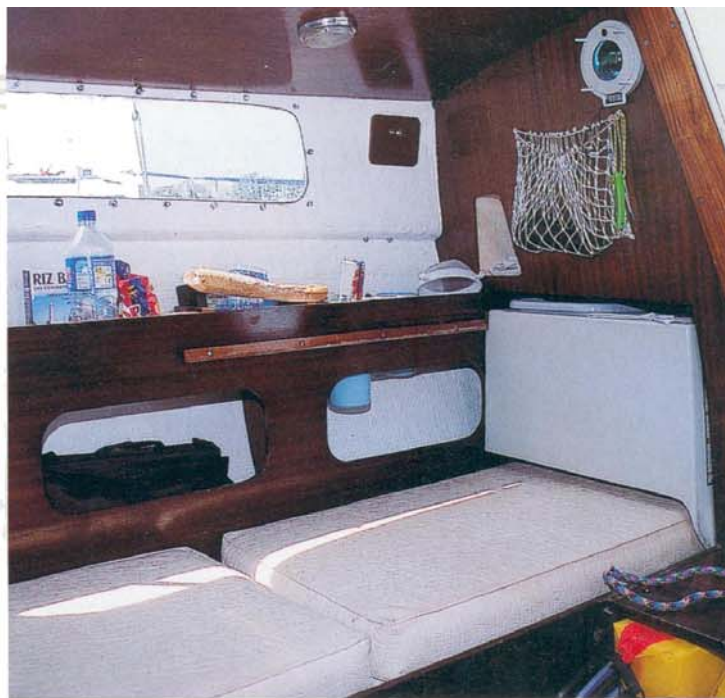
En couissant sous le banc du cockpit, la cuisine libère une belle couchette. Dispositif identique pour la table à cartes.
