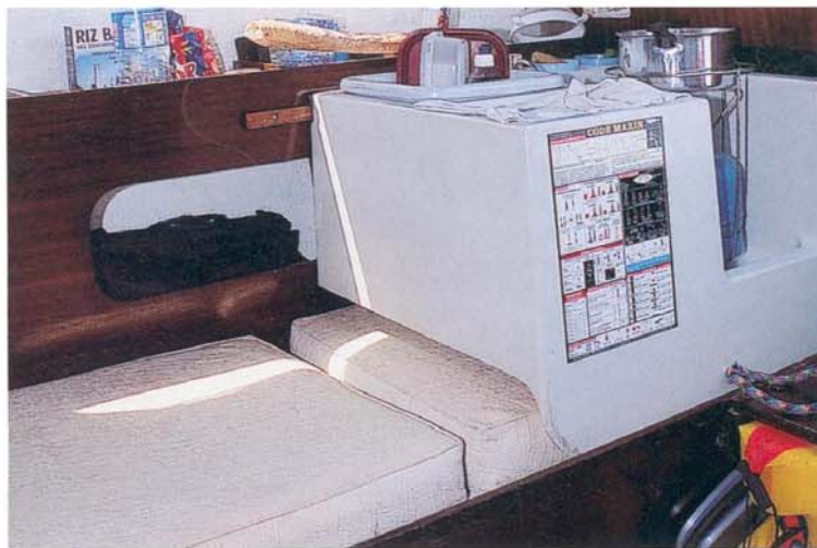
Le bloc cuisine moulé, simple et fonctionnel, s'escamote après usage.
