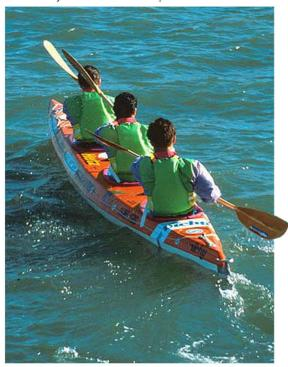
L é kayak triplace a été l'objet d'un aménagement particulier destiné au confort des rameurs, en abaissant le plancher afin que les pieds soient placés plus bas que le bassin.
